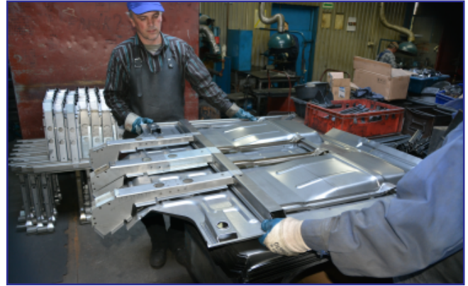
Bodengruppe für Fiat - teilweise handgefertigt Ein polnischer Zulieferer als Lieferant für die Fiat: Weil die Löhne niedrig und die Losgrößen klein, lohnt sich Automation kaum. Lieber selbst Hand anlegen – in Polen kein Problem
