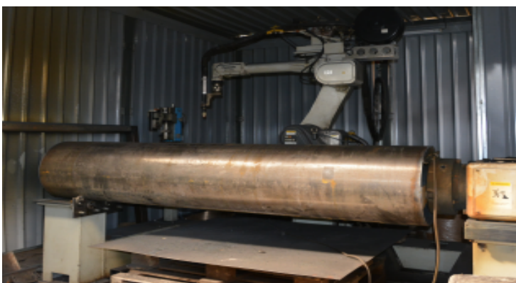
Fertigungs-Insel mit Roboter: Trennschneiden mit Roboter. Für eine schwedische Werft sind diese Teile bestimmt, die in Polen mit Roboter-Hilfe in Polen produziert werden. Der Automationsgrad in Polen ist geringer als in Deutschland
