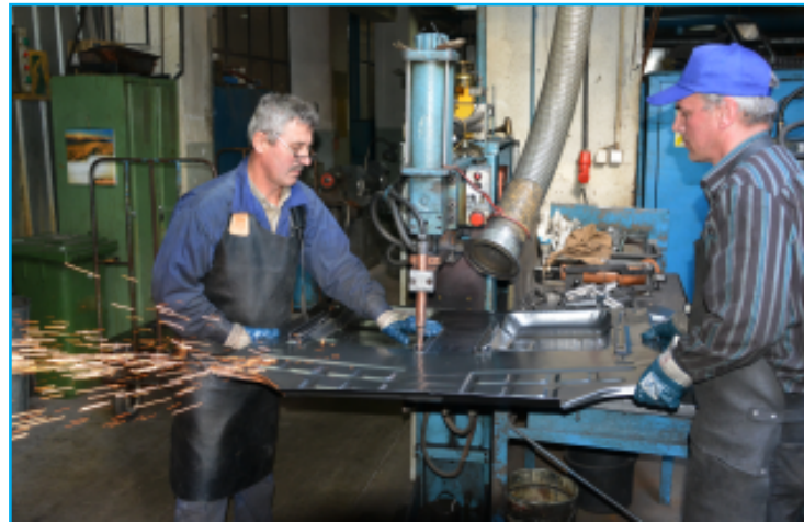
Bodengruppe für Fiat - teilweise handgefertigt Ein polnischer Zulieferer als Lieferant für die Fiat: Weil die Löhne niedrig sind, die Losgrößen aber klein, lohnt sich Automation kaum. Lieber selbst Hand anlegen - in Polen kein Problem
